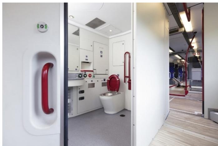
Sie verfügt über zusätzliche klappbare Haltegriffe und leicht erreichbare Bedienelemente, inklusive einer Notrufeinrichtung auch in Fußbodennähe.
